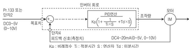
● 댄서 롤의 위치 검출을 피드백해서 PID제어를 하여 댄서 롤이 지정 위치가 되도록 제어할 수 있습니다. Pr.128 PID 동작 선택을 40~43으로 설정하면 댄서 제어를 합니다. 주속지령은 각 운전모드(외부, PU, 동신)의 주파수 지령이 됩니다. 댄서 롤의 위치 검출 신호로 PID 제어를 하여 주속지령에 가산합니다.
